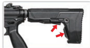
Appuyez sur le levier d'ajustement de la crosse pour déverrouiller.
