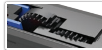
セクターギアが正常な位置
