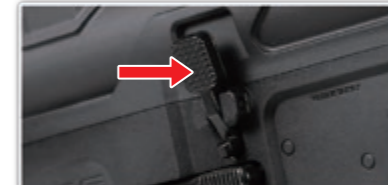
Rote la palanca para liberar el pestillo del cerrojo.
